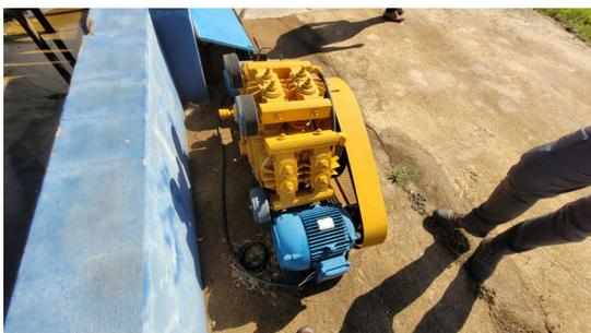
Compressor auxiliar ao processo de limpeza dos filtros existentes.
